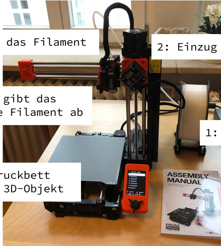
3: Extruder erwärmt das Filament
