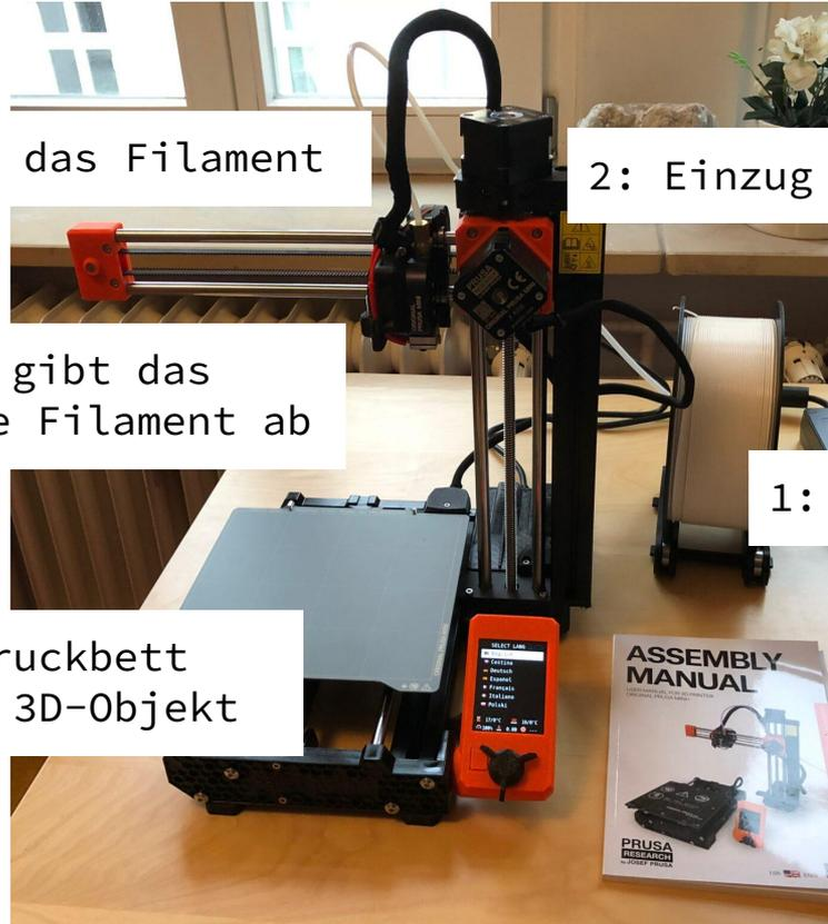
3: Extruder erwärmt das Filament
