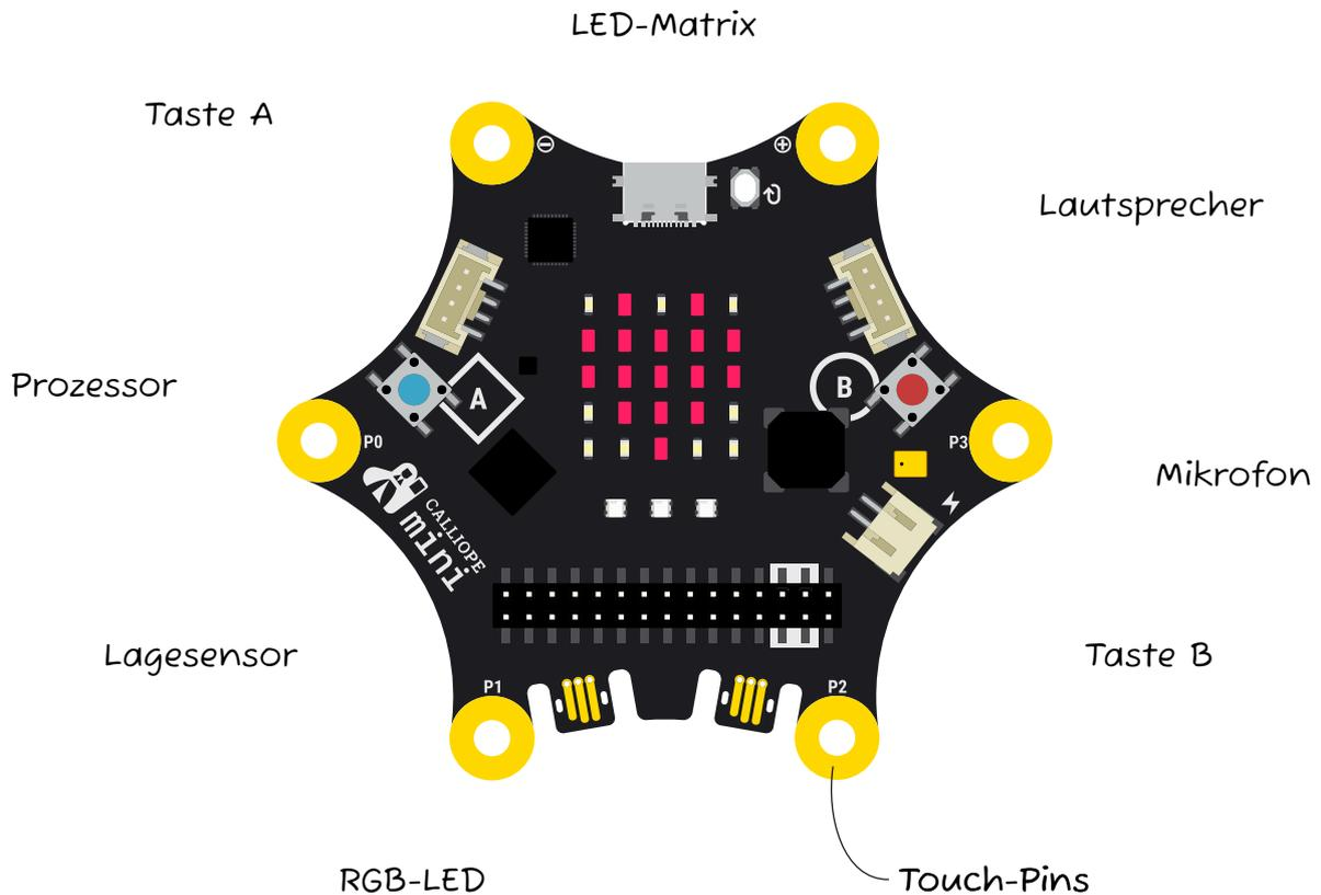
**Hinweis:** Ab dem Calliope mini 3 gibt es drei RGB-LEDs. Auch die Farbe und Anordnung einiger Bauteile hat sich leicht geändert. Du kannst die Projekte im Arbeitsheft mit allen Calliope mini Versionen umsetzen.
